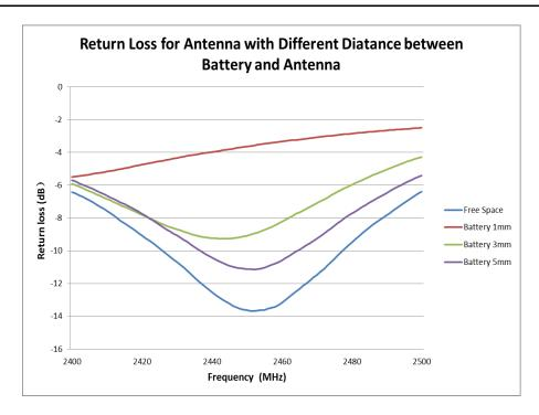
FIGURE 7.2.2 RETURN LOSS COMPARISON AT 2.4 GHZ BAND OF BATTERY DISTANCE FROM ANTENNA
