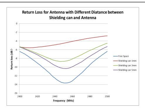
FIGURE 7.1.2 RETURN LOSS COMPARISON AT 2.4 GHZ BAND OF SHIELDING CAN DISTANCE FROM ANTENNA
