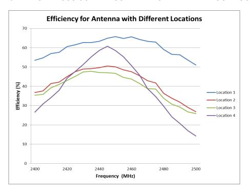
FIGURE 7.3.3 EFFICIENCY COMPARISON AT 2.4 GHZ BAND AT FOUR LOCATIONS
