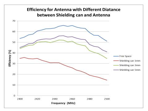
FIGURE 7.1.3 EFFICIENCY COMPARISON AT 2.4 GHZ BAND OF SHIELDING CAN DISTANCE FROM ANTENNA
