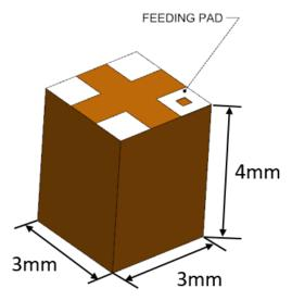
FIGURE 2.3.1 DIMENSION OF THE 2.4GHZ CERAMIC ANTENNA
