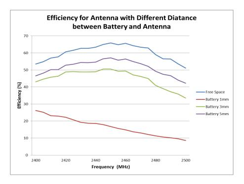
FIGURE 7.2.3 EFFICIENCY COMPARISON AT 2.4 GHZ BAND OF BATTERY DISTANCE FROM ANTENNA
