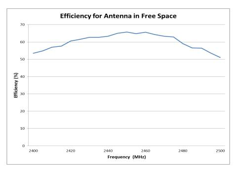
FIGURE 4.4.1 EFFICIENCY OF ANTENNA AT 2.4GHZ BAND IN FREE SPACE
