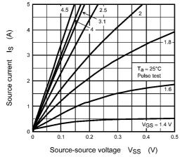
Fig. 10.1 I<sub>S</sub> - V<sub>SS</sub> (Note 6)
