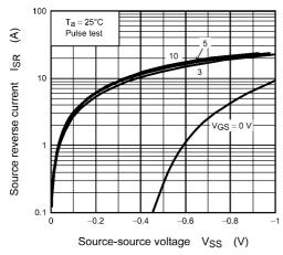
Fig. 10.7 I<sub>SR</sub> - V<sub>SS</sub> (Note 7)
